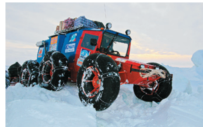
Колёсный полноприводный вездеход на шинах низкого давления «Торос-М» – собственная разработка Экспедиционного центра «Арктика», 2005 г.
