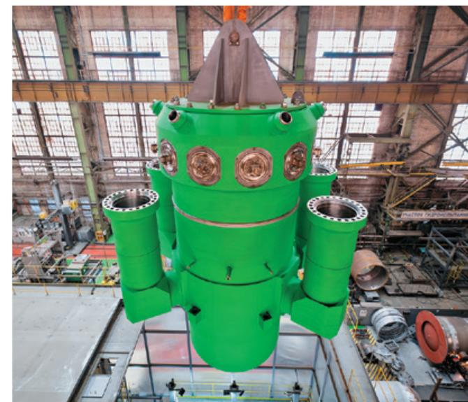
Подольск, 19 мая 2025 г. Машиностроительный завод «ЗиО-Подольск» завершил изготовление первого реактора РИТМ-400 для атомного ледокола «Россия»
